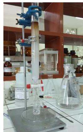
**Gambar 2.** Kromatografi kolom
